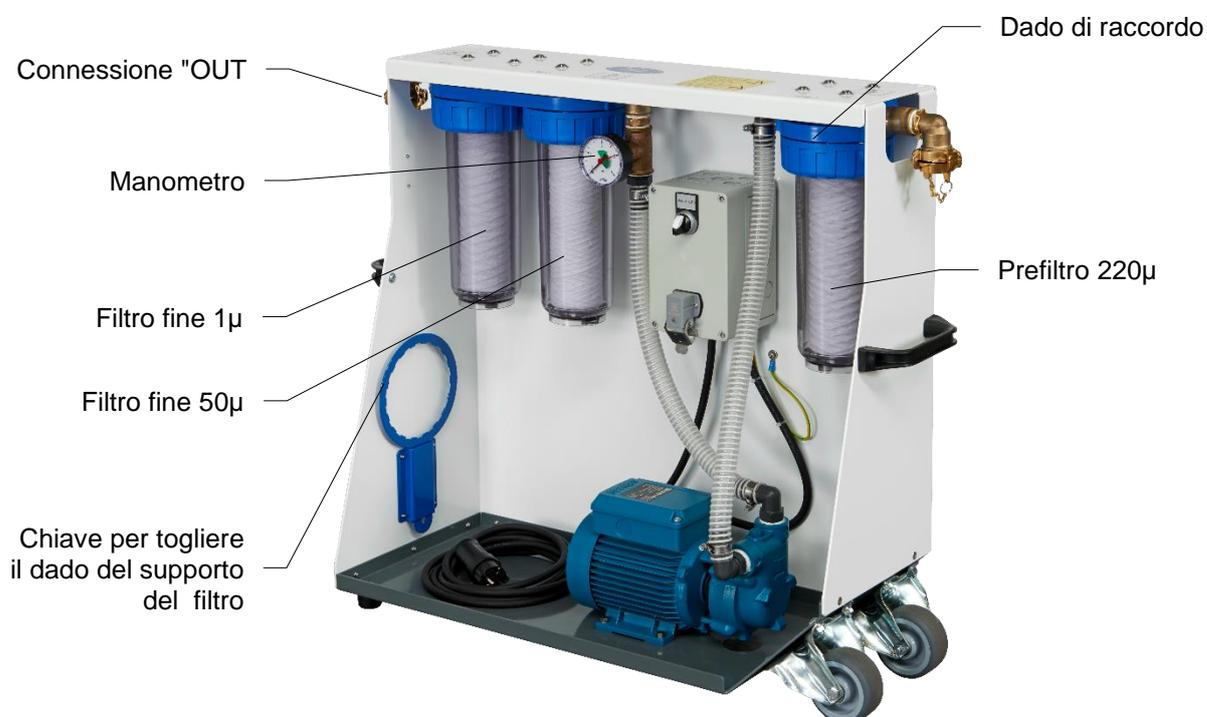
I filtri fini vengono monitorati tramite il manometro. Si consiglia di sostituire il filtro a circa 3 bar.
