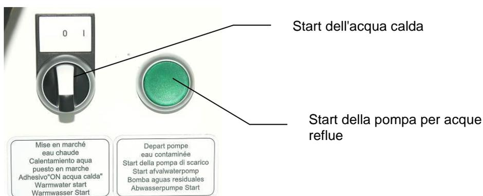
La pompa delle acque reflue può essere avviata manualmente premendo il pulsante "Start pompa acque reflue".
