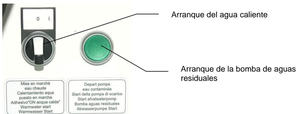
La bomba de aguas residuales puede arrancarse manualmente pulsando el botón "Arranque de la bomba de aguas residuales".
