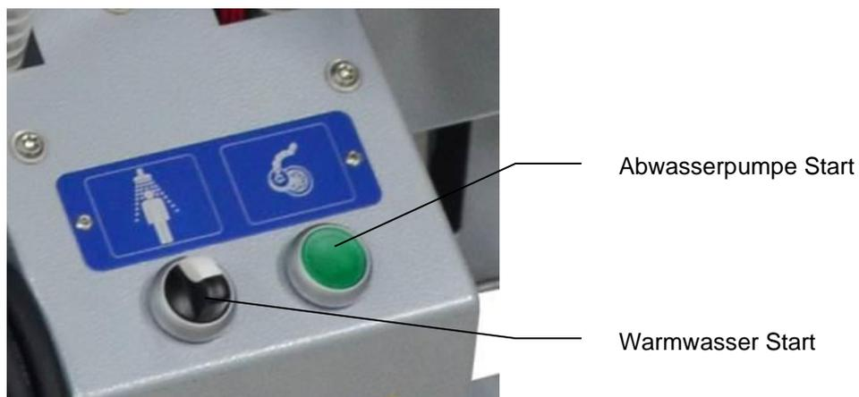
Durch Betätigen und Halten des Schalters „Abwasserpumpe Start“ kann die Abwasserpumpe manuell eingeschaltet werden.
