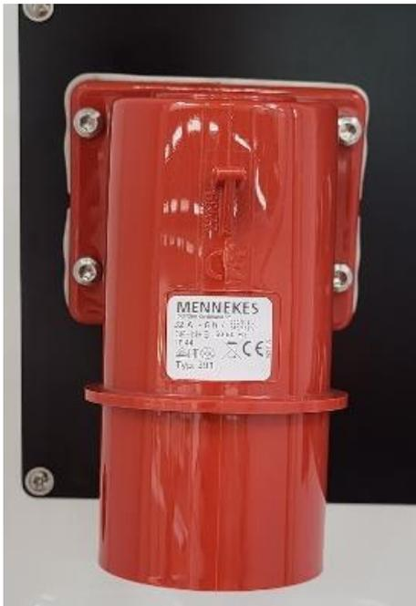
Der Entstauber ist mit einem Aufbaugerätestecker mit 32 A ausgerüstet. Sie wird mit einem CEE-Stecker an die Versorgung mit elektrischer Energie angeschlossen.
