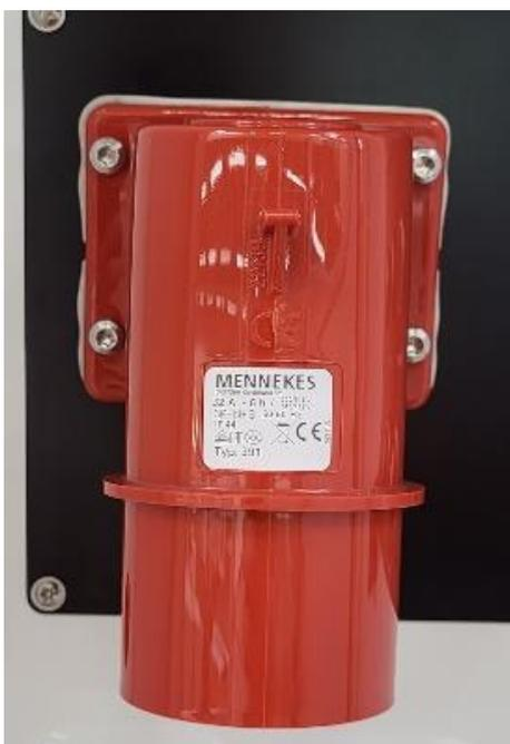
El separador de polvo está equipado con un enchufe de superficie de 32 A. Se conecta a la red eléctrica con un enchufe CEE.
