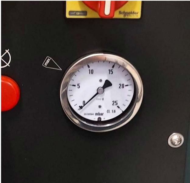
Wir empfehlen einen Filterwechsel bei ca. 7 mbar (700 Pascal), markiert durch den max.-Pfeil am Manometer.
