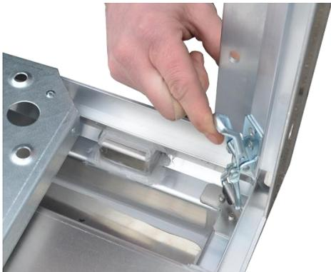
Inserire la guida della tapparella e il pannello a parete nelle staffe di montaggio del pannello a pavimento e del profilo angolare. Fissare la guida della tapparella con viti ad alette/dadi ad alette.
