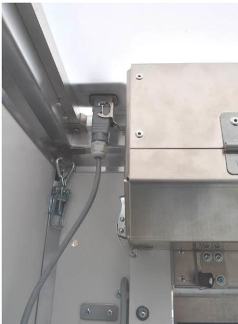
Collegare i cavi elettrici in dotazione ai tre attacchi sul lato esterno del tetto (dove le spine sono collegate anche dall'interno) e collegarli alla centralina di comando della chiusura forzata. Non è importante l'ordine in cui le tre spine sono collegate alla centralina.
