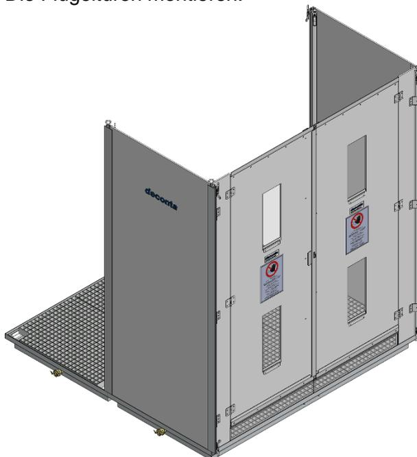
Die weiteren Wandelemente und Eckprofile montieren.
