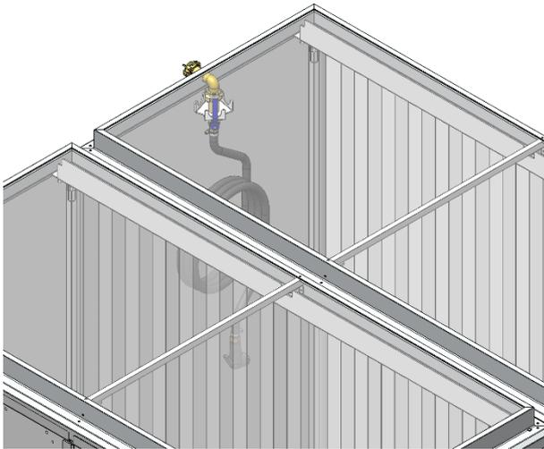
Dort, wo zwei Bodenelemente aneinander liegen, Verbindungsprofil auflegen. Dadurch wird ein Wasseraustritt aus der Schleuse verhindert.
