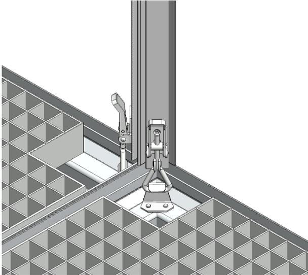
Wandelement in die Aufnahmewinkel des Bodenelements und des Eckprofils einsetzen.
