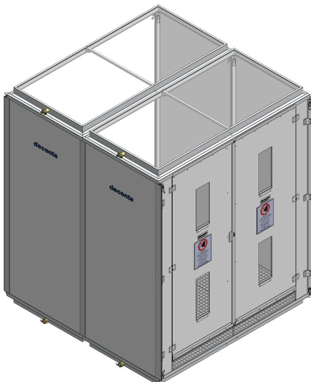
Montare il flap. Il flap è fissato con viti ad ala.
