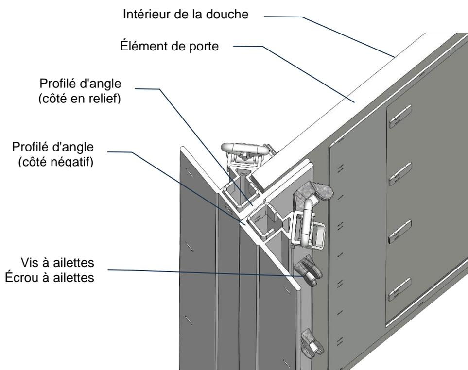
Placer l'élément de porte prémonté dans les équerres de réception de l'élément de sol et le serrer avec les éléments de sol à l'aide des fermetures rapides fixées aux extrémités des profilés d'angle.
