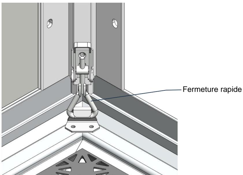
Insérer les éléments de paroi dans les équerres de réception de l'élément de sol et du profilé d'angle.
