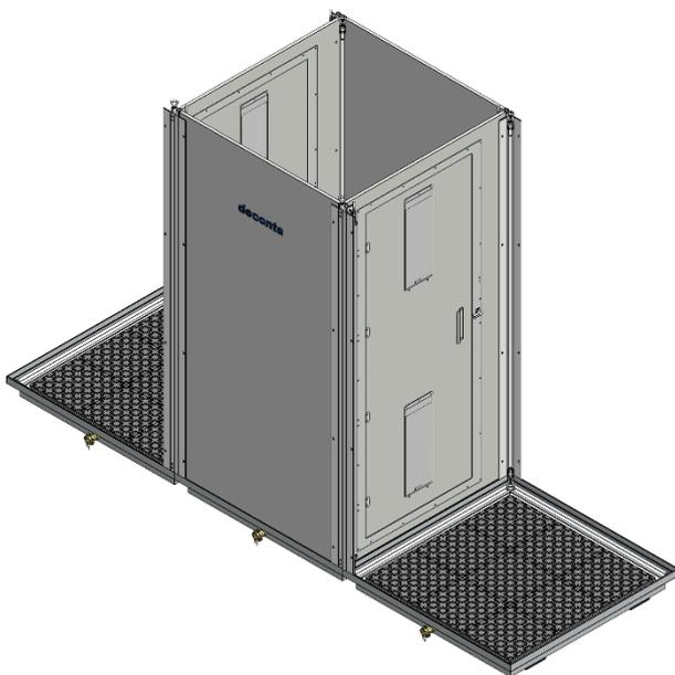
Poser l'élément de toit de douche avec le dispositif de douche et le serrer à l'aide des fermetures rapides.
