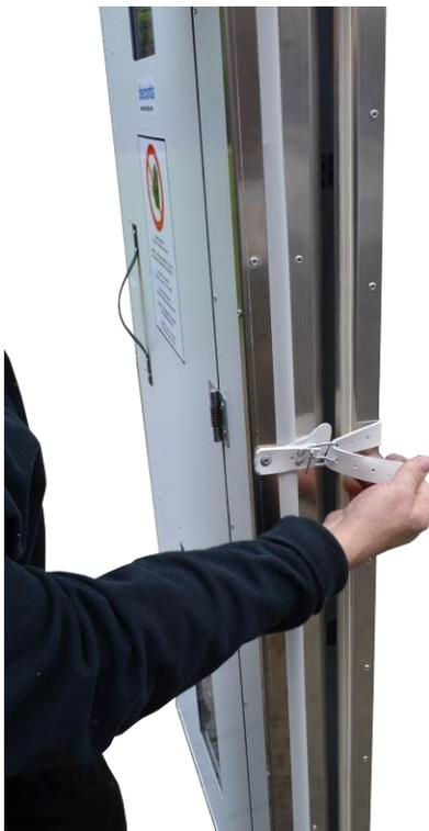
Aprire la camera dell'unità in modo che il telo in PVC sia in tensione.
