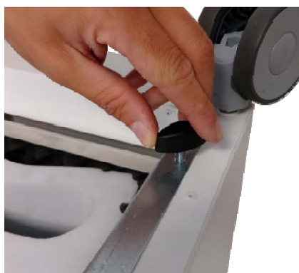
Abb. 25 Spanknöpfe, Spannprofile und Schalldämpferentnahme
