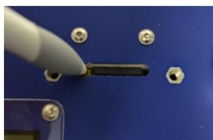
A l'aide d'un objet pointu , par ex. un stylo bille, appuyer sur le point jaune : Le support de carte SIM ressort et peut être retirer
