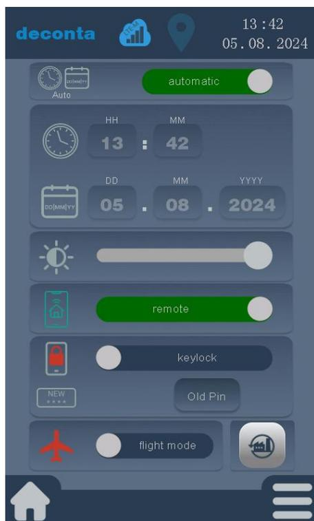
La funzione di controllo a distanza del collegamento del climatizzatore può essere attivata o disattivata utilizzando il pulsante "remote".
