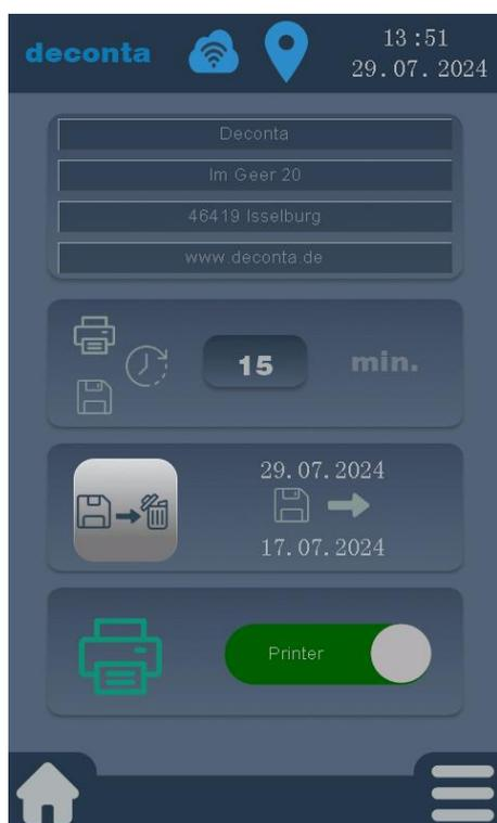
Qui è possibile inserire un testo specifico del cliente (ad esempio un indirizzo) in 4 righe, che viene poi stampato sulla stampante.
