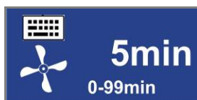
Abb. 46 Einstellung der Zeit, die das Unterdruckhaltegerät weiter läuft, nachdem alle Personen die Schleuse verlassen haben
