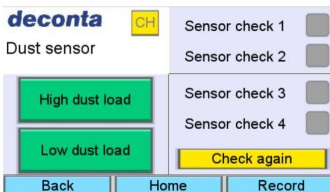
Les valeurs mesurées par les capteurs à filtre peuvent être affichées sous forme de graphique en cliquant sur le bouton "Record".
