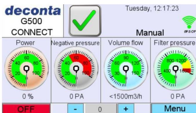
Pour surveiller le filtre, la pression du filtre (Filter pressure) s'affiche sur l'écran de la commande. Si l'affichage atteint la zone rouge, veuillez d'abord remplacer les préfiltres et les filtres intermédiaires. Si la valeur affichée baisse de 100 pascals ou plus, l'appareil peut continuer à fonctionner. Si la valeur baisse de moins de 100 pascals, le filtre HEPA doit être remplacé.
