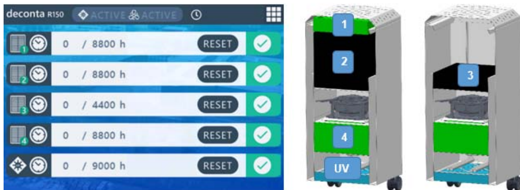
Abb. 14 Betriebsstunden und empfohlene Betriebszeit der einzelnen Stufen
