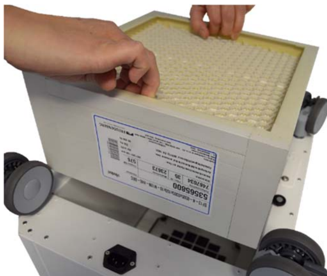
Abb. 29 Rimuovere il filtro HEPA
