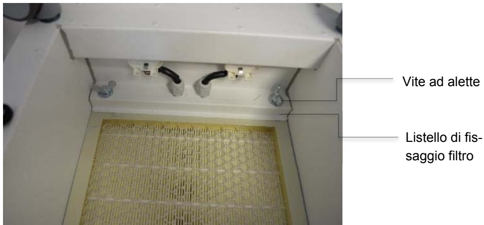
Abb. 28 Viti ad alette e i listelli di fissaggio filtro
