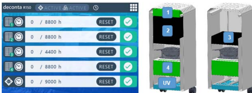
Abb. 14 Ore di esercizio e durata di funzionamento consigliata per i singoli stadi
