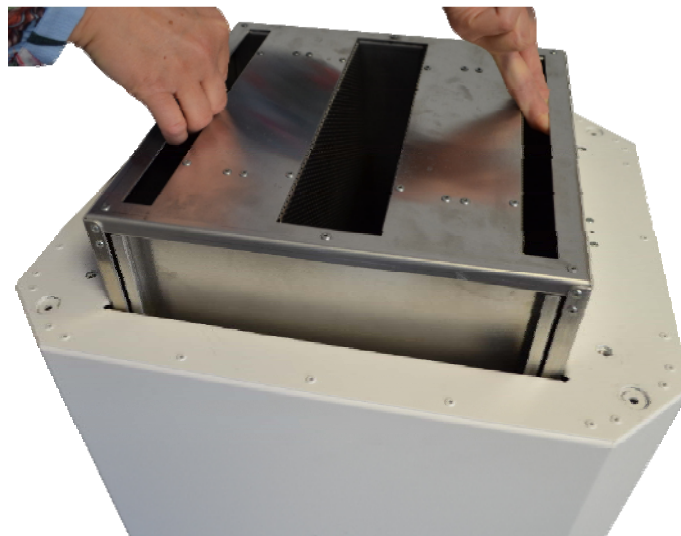
Abb. 33 Desmontaje de la celda de carbón activado
