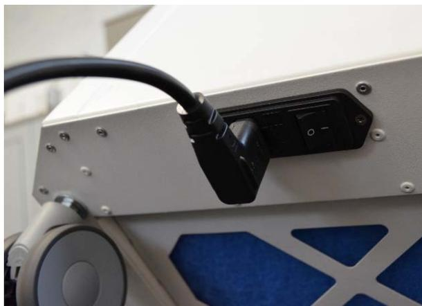
Abb. 1 Interrupteur d'alimentation
