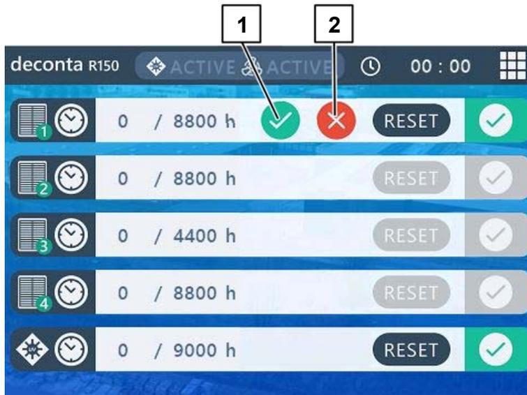
Abb. 19 Bouton RESET pour réinitialiser le temps de fonctionnement
