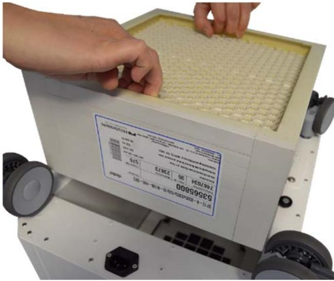
Abb. 33 Retirer le filtre HEPA
