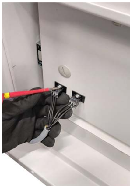
Abb. 29 Steckverbindungen an der Schublade mit Schlitzschraubenzieher lösen
