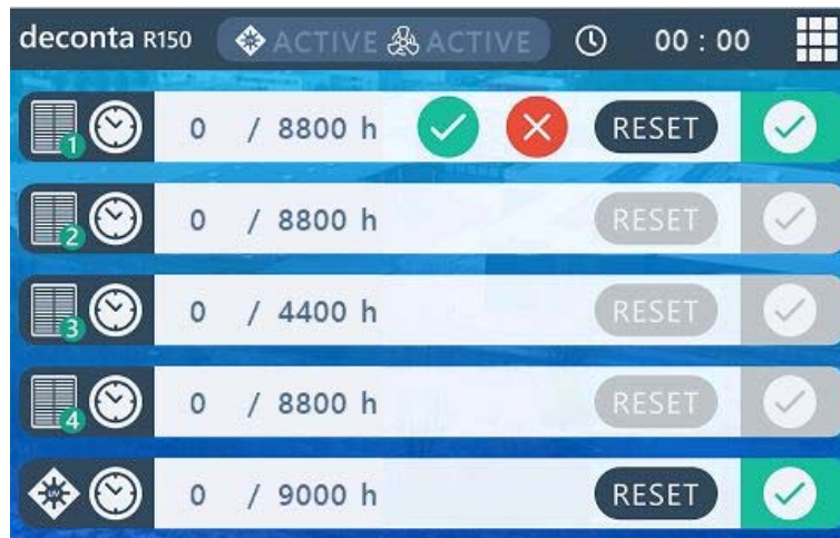
Abb. 16 RESET-Button für das Zurücksetzen der Betriebszeit
