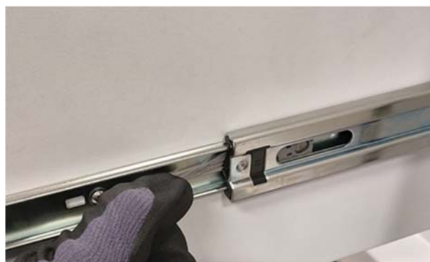
Abb. 32 Entriegeln der Auszugsschienen
