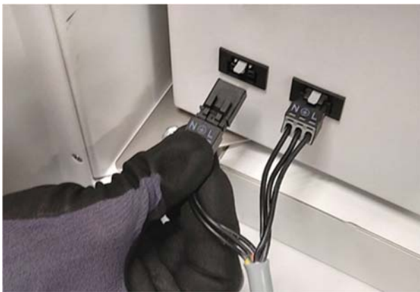
Abb. 39 Steckverbindungen an der Schublade
