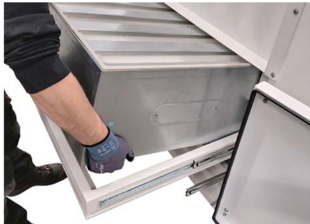
Abb. 35 Entnahme des HEPA-Filters
