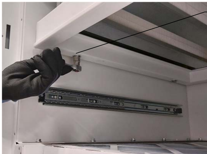
Abb. 33 Schrauben zum Absenken des HEPA-Filters
