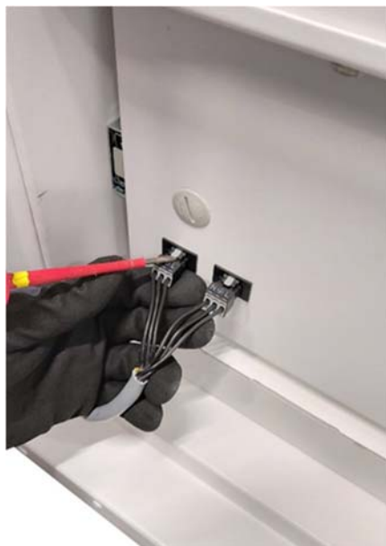
Abb. 29 Desserrer les fiches du tiroir à l'aide d'un tournevis à tête plate
