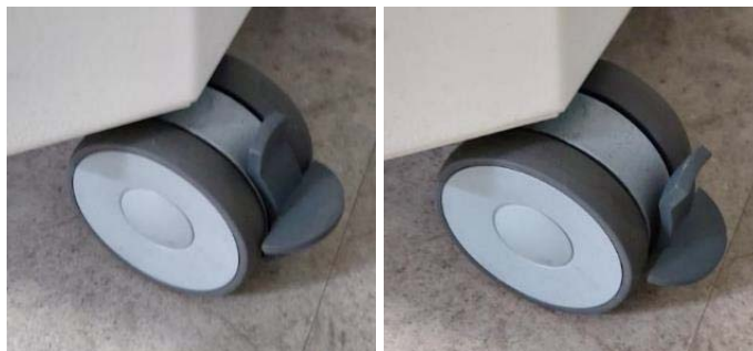
Abb. 6 Frein desserré (à gauche) et frein serré (à droite)
