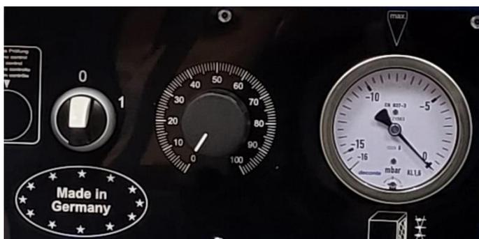
La tabella seguente mostra i valori del display per una sostituzione del filtro. Se il display raggiunge questo valore, sostituire prima il prefiltra. Se il valore visualizzato scende di 100 Pascal o più, l'apparecchio può continuare a funzionare. Se il valore diminuisce al di sotto di 100 Pascal, è necessario sostituire il filtro HEPA.
