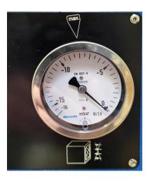
Der folgenden Tabelle können Sie die Anzeige-Werte für einen empfohlenen Filterwechsel entnehmen. Erreicht die Anzeige diesen Wert, tauschen Sie bitte zuerst den Vorfilter. Sinkt der Anzeige-Wert um 100 Pascal oder mehr, kann das Gerät weiter betrieben werden. Sinkt der Wert um weniger als 100 Pascal, muss der HEPA-Filter erneuert werden.
