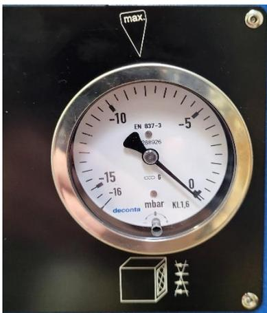
La tabella seguente mostra i valori del display per una sostituzione del filtro corretta. Se il display raggiunge questo valore, sostituire prima il prefiltro. Se il valore visualizzato scende di 100 Pascal o più, l'apparecchio può continuare a funzionare. Se il valore diminuisce di meno di 100 Pascal, è necessario sostituire il filtro HEPA.
