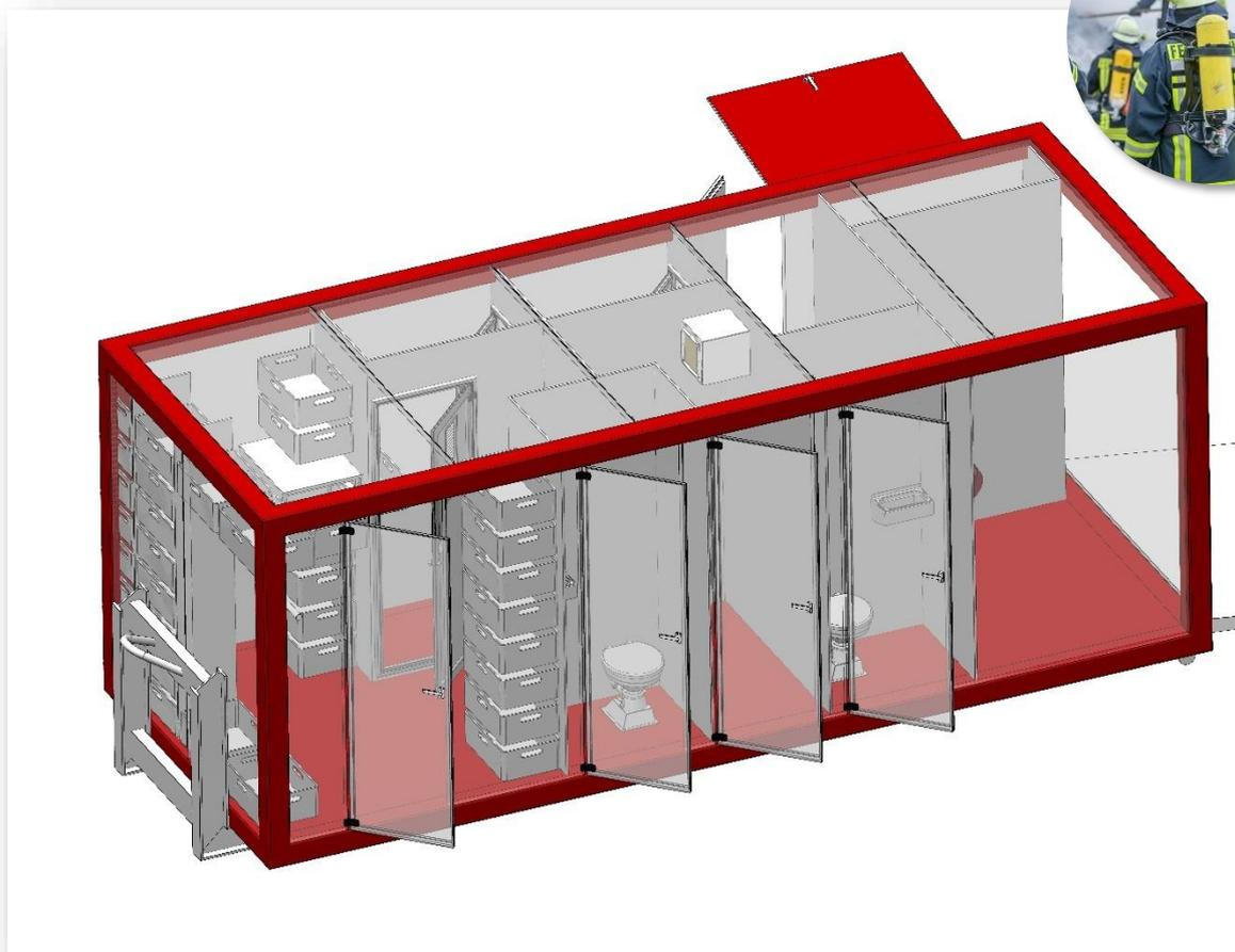
Das Feuerwehr Abrollbehälter Dekon-P ermöglicht an Einsatzstellen eine schnelle und sichere Dekontamination von Personal und Geräten gemäß DGUV Information 205-035 und vfdb-Empfehlung MB 10-13. Insbesondere bei einem Innenangriff zur Brandbekämpfung wird die persönliche Schutzausrüstung (PSA) sowie mitgeführte Geräte durch verschiedenste Gefahrstoffe kontaminiert. Nicht selten besteht sogar die Gefahr einer Kontamination mit Asbest, der höchst gesundheitsgefährdend (Feuerkrebs) ist.
